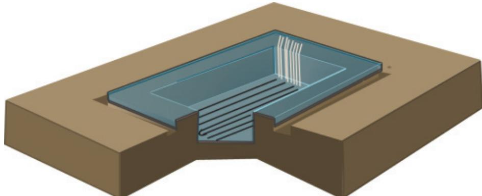
[그림 10] 저압분산고무질호스(유니바이오프스-바닥) 및 엑셀파이프(벽면) 설치개요도
