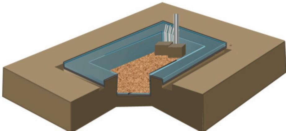
[그림 11] 매몰지 내부 침출수 관찰용 유공관 설치 개요도
