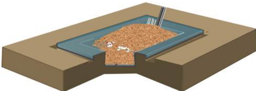
[그림 13] 호기성 호열미생물을 이용한 소취용 봉분층 만들기 개요도
